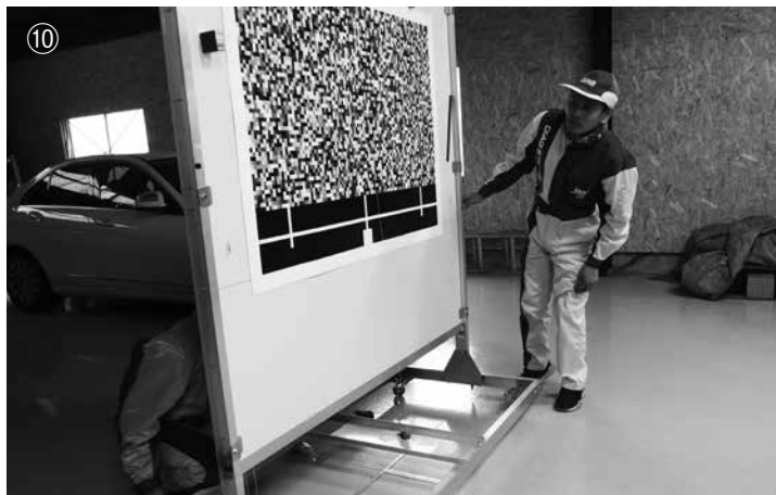
⑩ランダムチャートの縦線にデジタル距離計のレーザーが通っているか確認。
