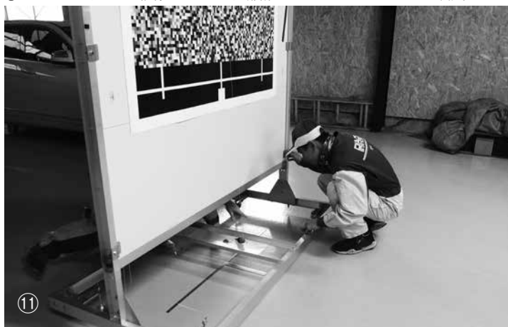
⑪更にデジタル距離計のレーザーが床面に置いた差し金の目盛に左右それぞれ当たっているかを確認。
