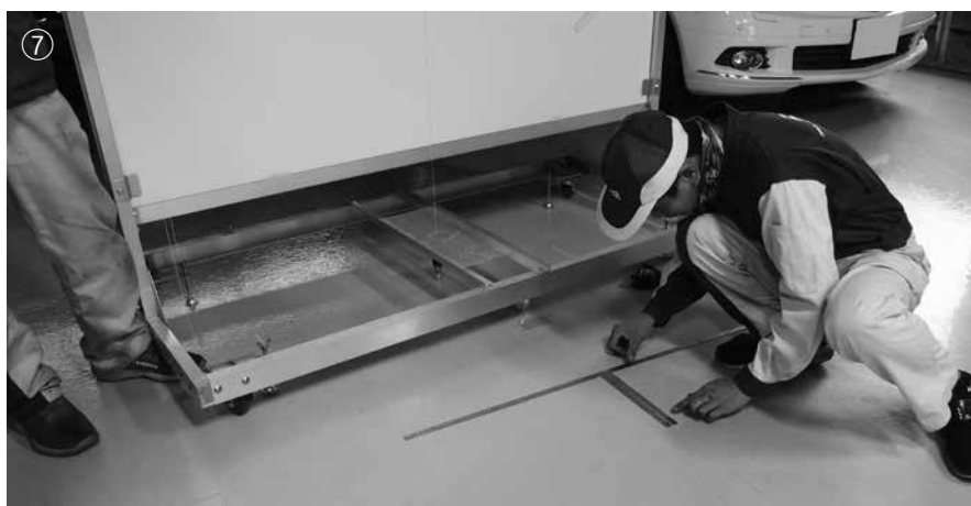
⑦ スズキの場合、ターゲット間距離の左右部分が等間隔になる必要があり、したがって差し金を使ってターゲット設置位置をマーキングする。
